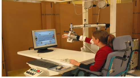
Şekil II.29 GENTLE/s Rehabilitasyon Sistemi
