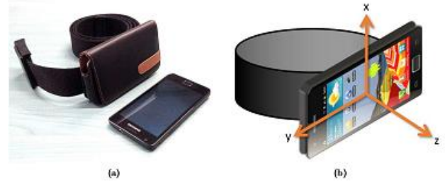
Şekil 2: (a) deneylerde kullanılan akıllı telefon ve kemerli kılıfı (b) Algılayıcının eksen takımı [2].
