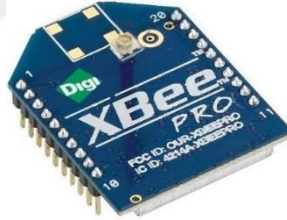
Şekil 3.15 Kablosuz Haberleşme Modülü (XBee)
