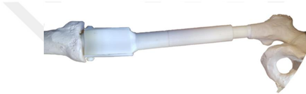
Şekil 3.4 Geliştirilen Protezin FDM (Fused Deposition Modelling) Teknolojisiyle Üretilmiş Prototipi
