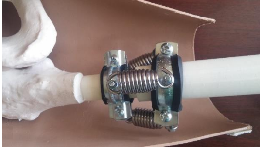
Şekil 3.33 Yaylar Kullanılarak Yumuşak Doku Mekanik Empedansının Modellenmesi
